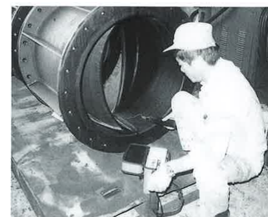
検査工程 製品検査はピンホールテスト、硬度、厚さ、外観検査の他、御指定により気密テスト、攪拌テスト等も行います。
